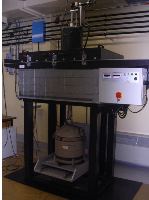
Fig. 8 - Apparato sperimentale di analisi per attivazione neutronica.
