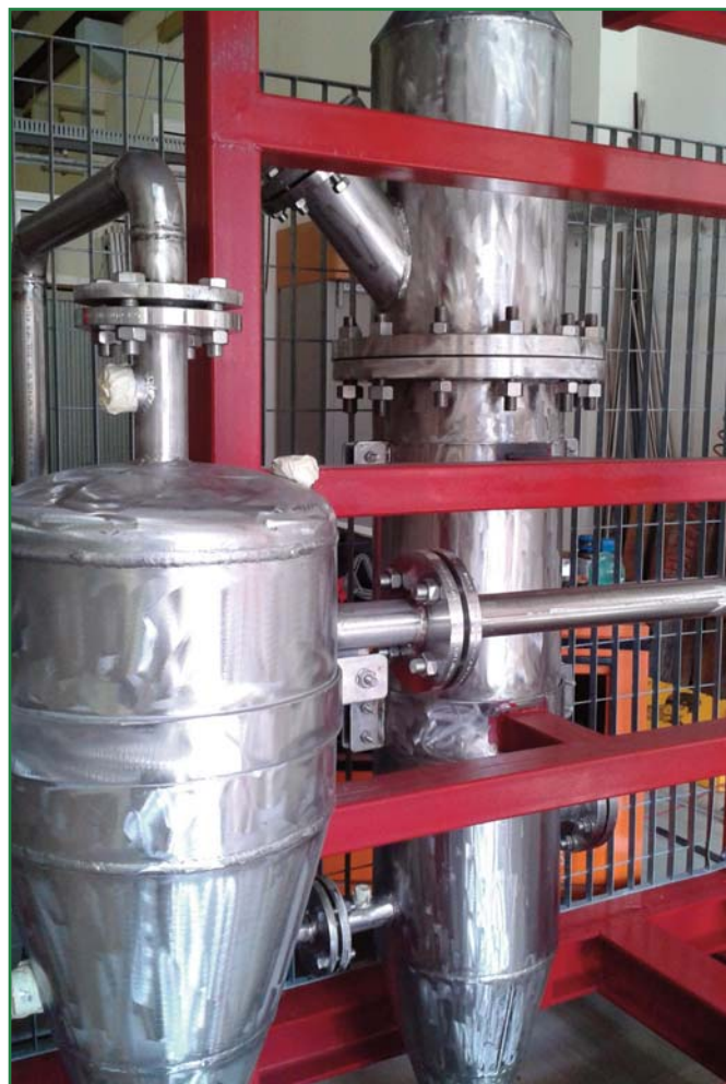
Particolare dell'impianto sperimentale GESSYCA relativo al Gassificatore
