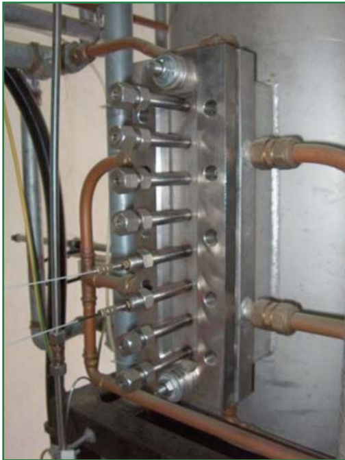
Accesso multi-strumentato con sensori ottici ODC® per misure di stabilità di combustione e velocità
