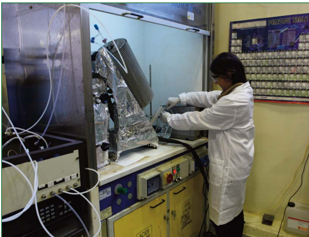
Forno tubolare (1200 °C) con reattore in quarzo per lo studio della reazione di metanazione da CO 2 e H 2 con flussimetri di massa e gascromatografo
