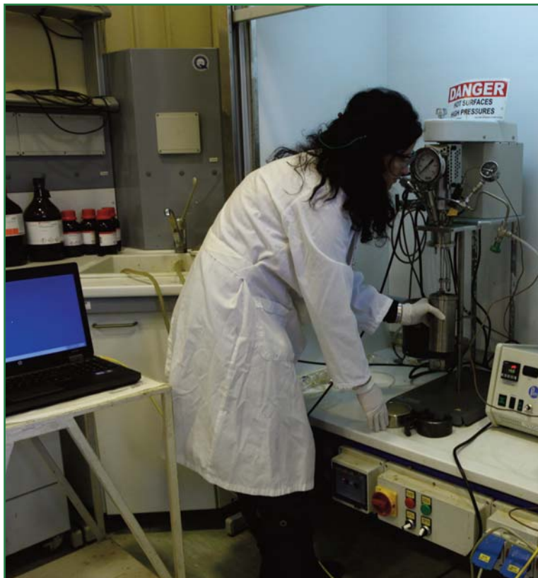
Reattore metallico per alte pressioni (400 °C, 200 bar)
