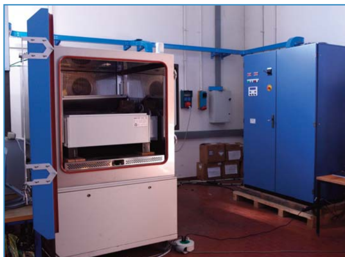
Laboratorio Prova Batterie – Camera Climatica EOS 1000 e Ciclatore 140kW; 0-560V; 250A
