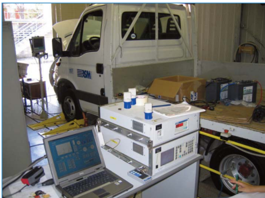
Prove su Daily alimentato a miscele metano-idrogeno
