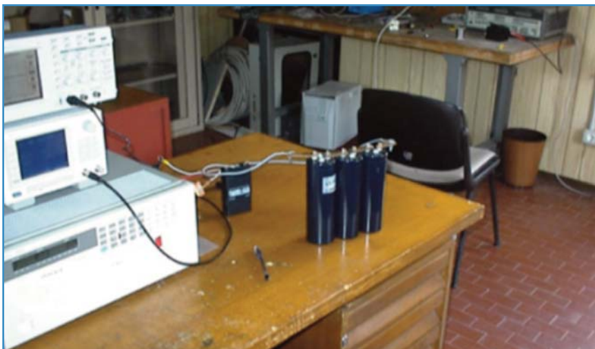
Celle di supercondensatori in prova
