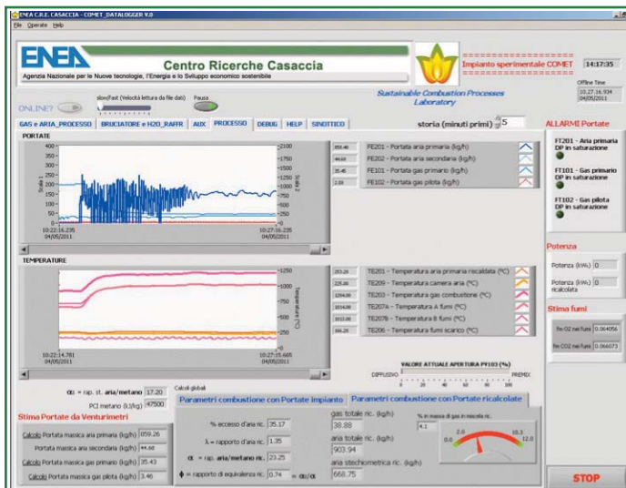
Impianto COMET HP – ENEA Casaccia: interfaccia operatore del datalogger
