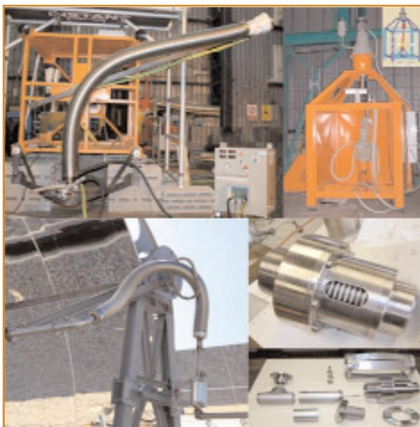
Qualificazione di componenti speciali (flessibili e giunti) per impianti solari termodinamici
