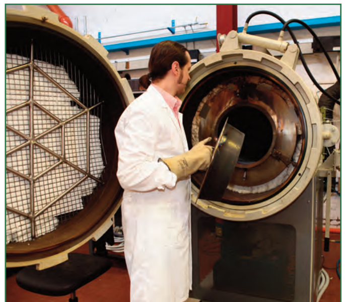
Forno per processo PIP (Polymer Impregnation Pyrolysis)
