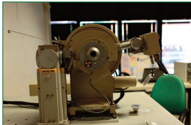
Diffrazione di polveri, XRD (Philips Goniometro verticale PW1820, con unità di controllo PW1710)
