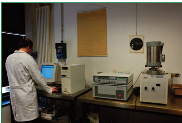
Analisi termica differenziale, TG-DTA, fino a 1700 °C (NETZSCH STA 409 C)
