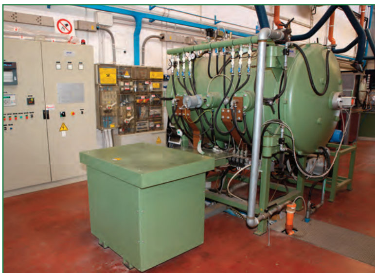
Forno di sinterizzazione in atmosfera inerte fino a 2200 °C
