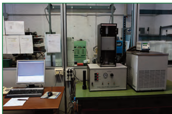
Termoflussimetro 2022 della ANTER Corporation. Misure di conducibilità termica nel range -30÷300 °C
