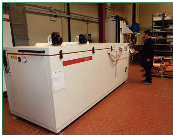
Camere Climatiche Vötsch Industrietechnik Modello VBT 03/1000 con operatività entro -40 \div 80 °C. Controllo automatico del sistema in aria ed in acqua
