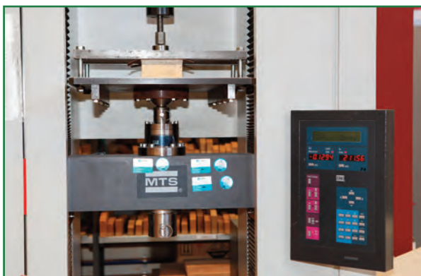
Macchina monoassiale a vite per prove meccaniche con cella di carico da 20 e 150 kN. Costruttore: MTS
