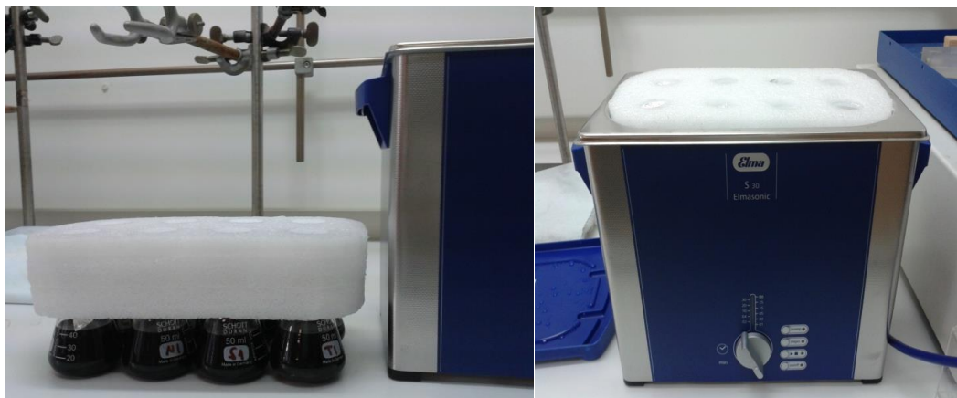
Figura 2 e 3. Dispositivo usato per le prove di lisciviazione con ultrasuoni
