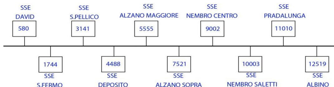
Figura 2. Sottostazioni di alimentazione della linea
