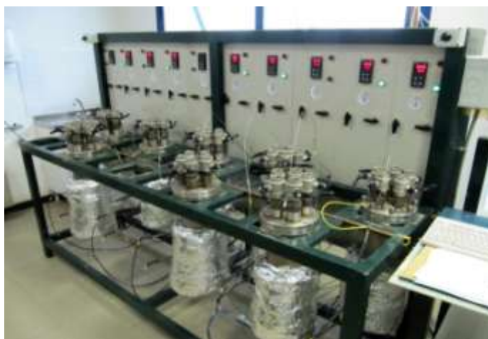
Figura 1. Impianto utilizzato per le prove di corrosione statiche su i due acciai in una miscela ternaria di i nitrati fusi a 550°C
