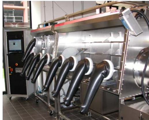
Glove Box per lo sviluppo di celle solari polimeriche
