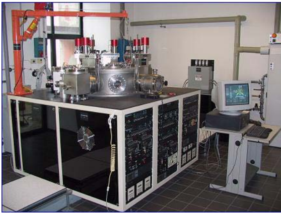
Impianto per la deposizione di film sottili di silicio con tecnica PECVD – VHF PECVD
