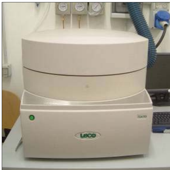
Fig 4: Analizzatore termogravimetrico per l'analisi dell'umidità.
