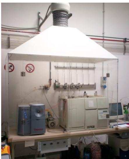
Figura 6. Apparato da laboratorio per le misure di adsorbimento di H 2 S
