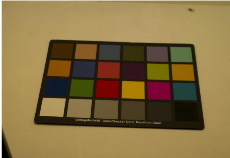
figura 9 color checker sotto lampada a filamento di tungsteno corretta per luce naturale con filtro blu
