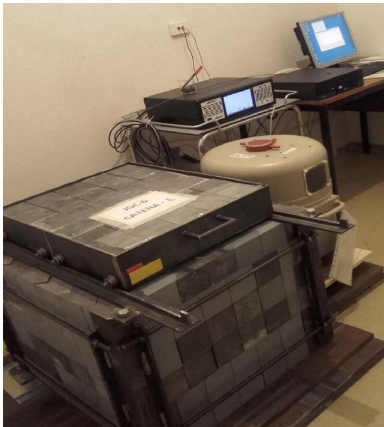
Foto 7 – Catena di Spettrometria Gamma a basso fondo
