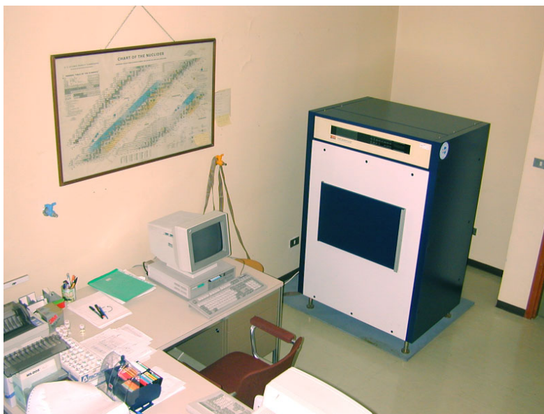
Foto 5 – Spettrometro ultra low level a scintillazione liquida
