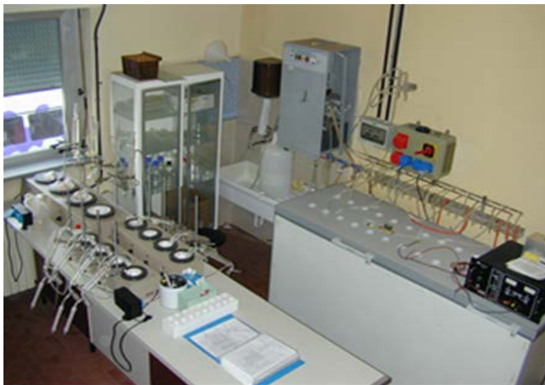
Foto 4 – Sistema per l'arricchimento elettrolitico del trizio in campioni acquosi
