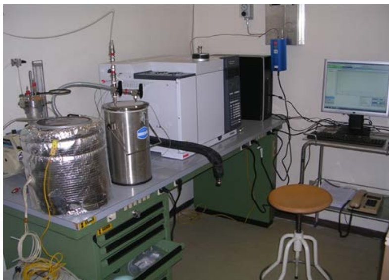
Foto 6 – Sistema per la concentrazione e separazione di Gas Nobili Radioattivi in atmosfera
