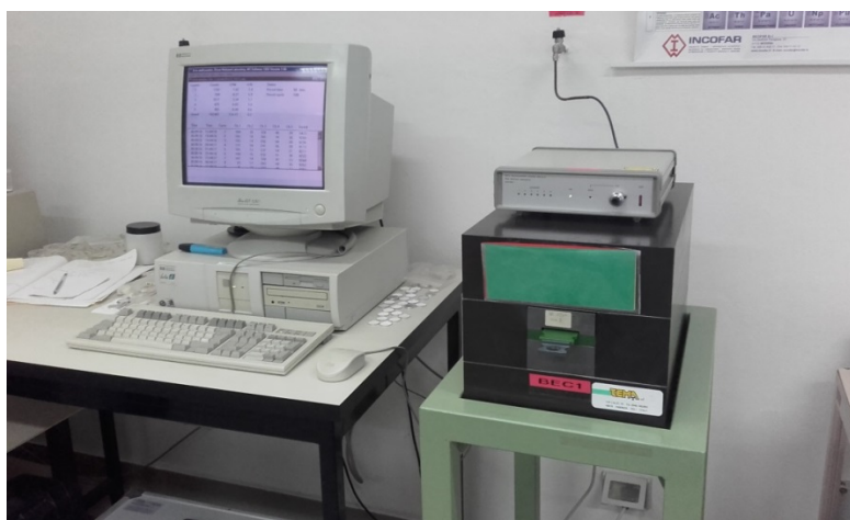
Foto 3 – Contatore Beta a basso fondo a flusso di gas
