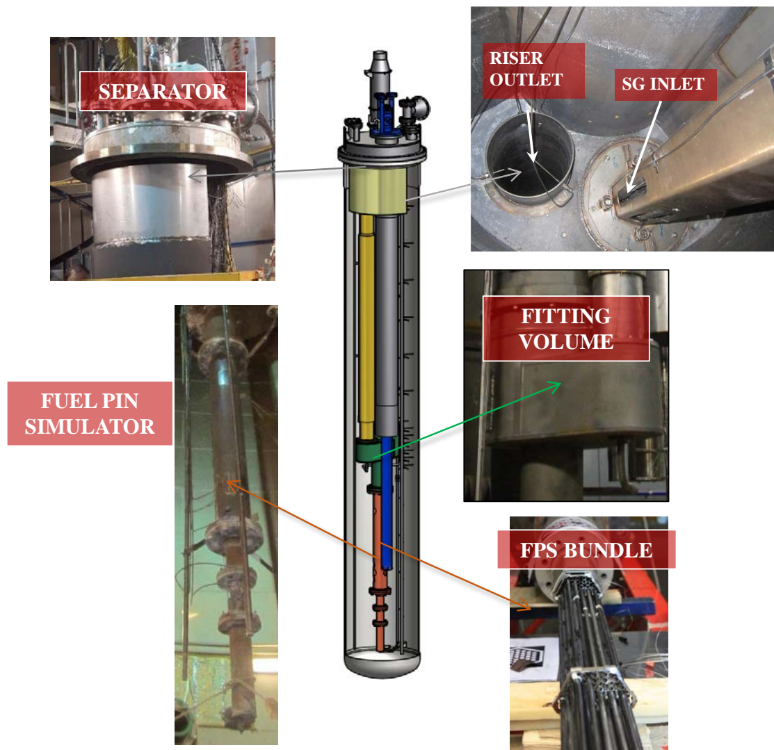
Componenti principali della sezione di prova HERO
