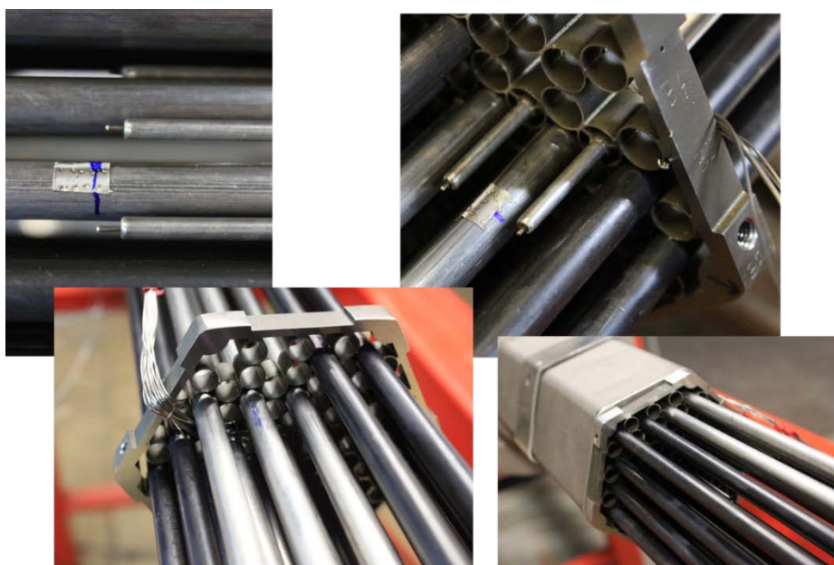
Simulatore del Fuel Pin Bundle per la sezione di prova HERO
