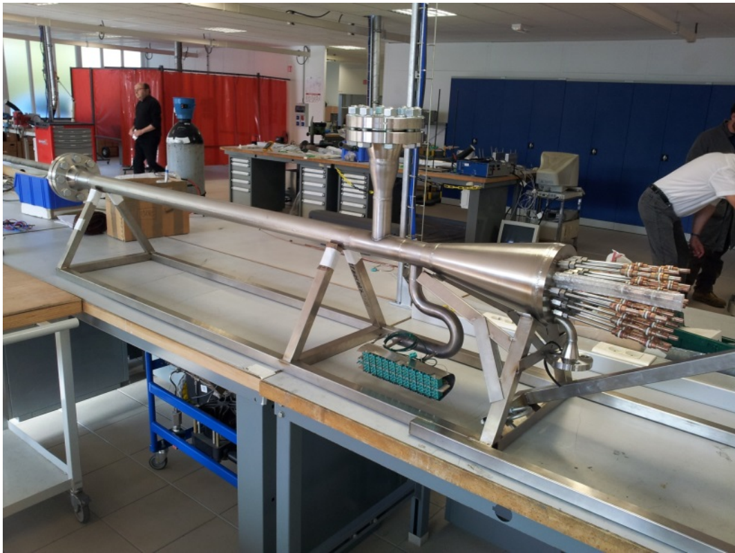
Sezione di prova Fuel Pin Bundle Simulator FPS-19250.
