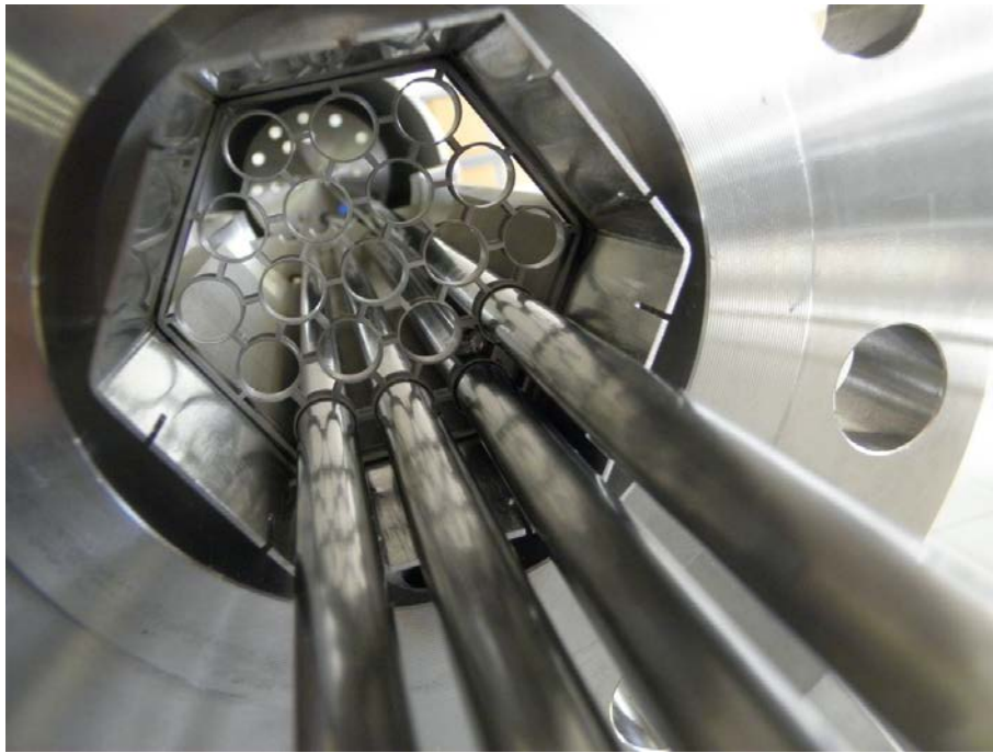
Sezione di prova Blockage Fuel Pin Simulator (BFPS) durante l'assemblaggio.
