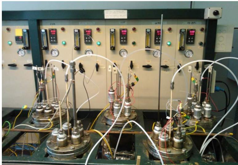
Capsule grandi (ENEA) per prove di corrosione in Pb, Pb-Bi e Pb-Li (fino a 12 Kg, temperatura max. 550°C)
