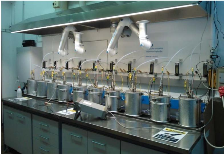
Capsule piccole (fabbricate da KIT) per prove di corrosione in Pb e Pb-Bi (760 g di metallo liquido, temperatura max. 550°C)
