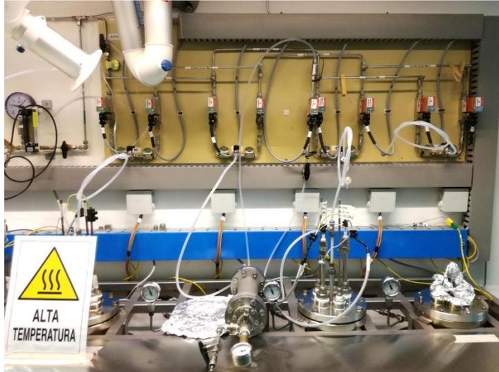
Capsule grandi (ENEA) per prove di corrosione ad alta temperatura in Pb, Pb-Bi e Pb-Li (fino a 12 Kg di metallo liquido, temperatura max. 750°C)
