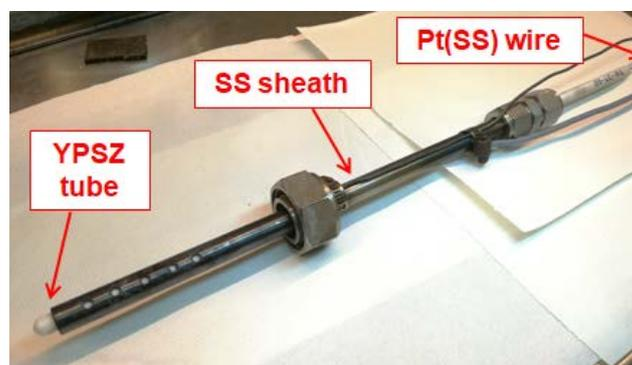
Sensore di ossigeno per piombo liquido fluente
