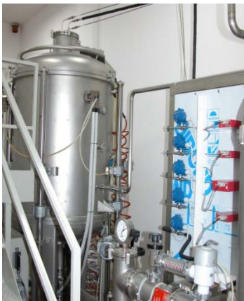
Impianto CVI per la produzione di CFCC
