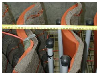
Prova gelo/disgelo su tegole in laterizio
