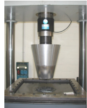
Prova di intrusione su pannelli in composito per vetture F1
