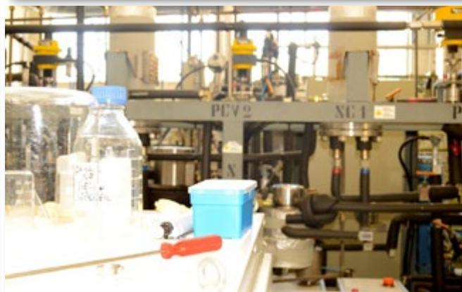
La **Hall tecnologica C25** e gli impianti pilota di filtrazione a membrana. I processi separativi a membrana trovano un vasto campo applicativo a livello industriale, che vanno dal settore biomedico a quello alimentare, al trattamento dei reflui industriali e alla generazione di acqua potabile, a partire da quella di mare. I sistemi separativi a membrana costituiscono un metodo molto efficace per il recupero e riutilizzo dell'acqua e di altre sostanze chimiche di interesse commerciale
