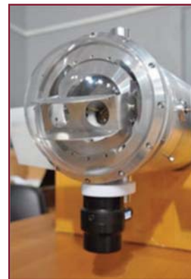
VENUS - Prua con alloggiamento telecamera e sonar
