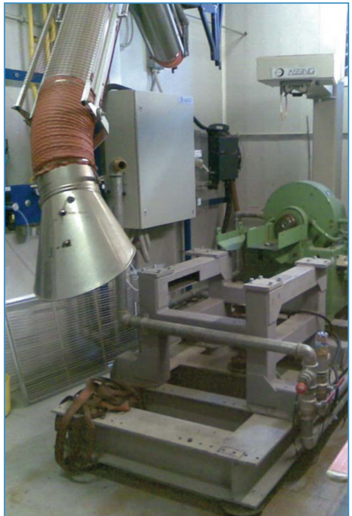
La Sala allestita con una culla per motori termici e un freno a correnti parassite
