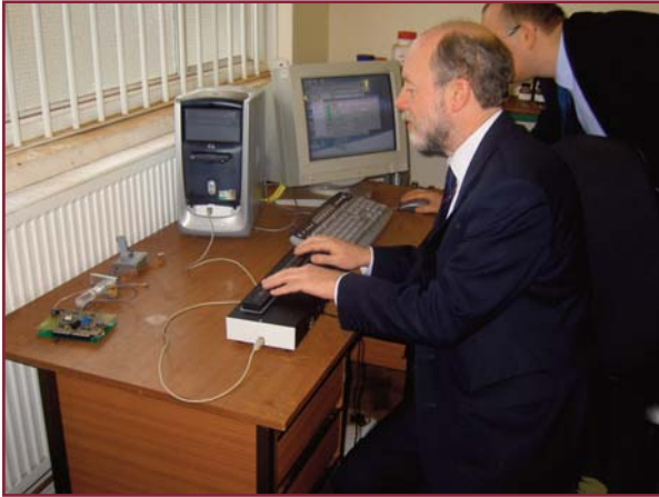
Interfaccia tattile realizzata mediante fluido elettroreologico nel progetto europeo Itactl - Smart Interactive Tactile Interface
