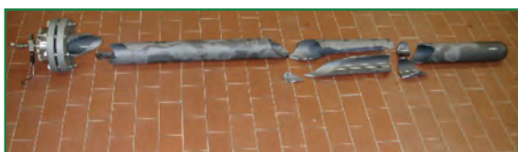
Prova di pressurizzazione su tubo in carburo di silicio. Tubo rotto dopo la prova
