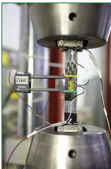
Prova di trazione su composito polimerico rinforzato con fibre di carbonio, strumentato con rosetta estensimetrica ed estensometro. Sistema di prova nella configurazione iniziale
