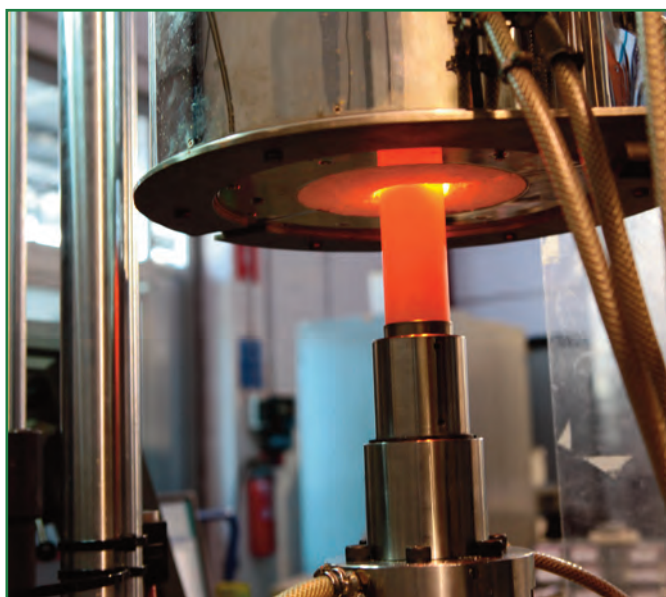
Macchina MTS attrezzata con forno per prove di flessione fino a 1500°C – Prova in corso
