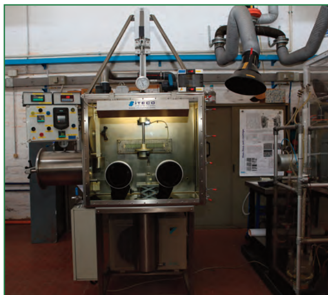
Dip coater in ambiente controllato per film sottili e rivestimenti protettivi e funzionali
