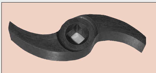
Figura 12 girante della pompa primaria di un LFR, interamente realizzata in Ti_3SiC_2 Fonte: ENEA
