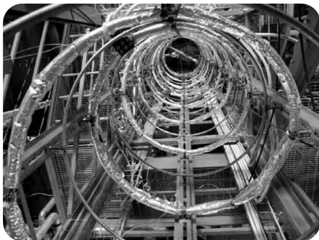
Figura 5 Impianto IETI: sperimentazione termo-fluidodinamica su generatori di vapore per reattori LWR avanzati Fonte: SIET
