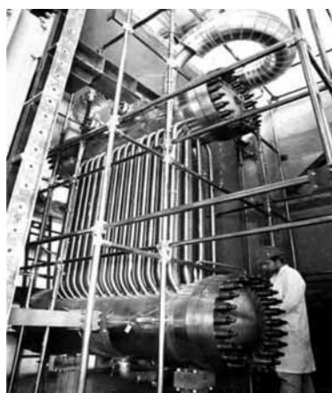
Scambiatore di Calore per reattore SBWR-GE (Potenza Termica: 22 MW)
