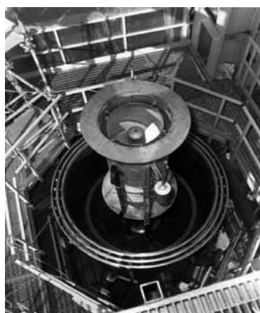
Separatore Acqua-vapore per reattore ABWR Toshiba
