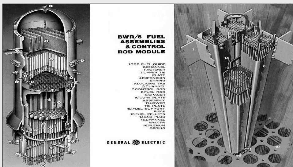
Figura 6 Vessel in pressione (a sinistra) ed elemento di combustibile di un BWR (a destra) Fonte: General Electric, USA
