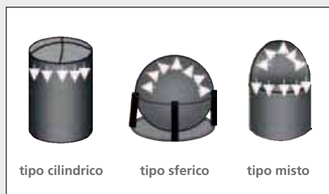
Figura 3 Le tre principali forme geometriche per il contenitore esterno Fonte: ENEA
