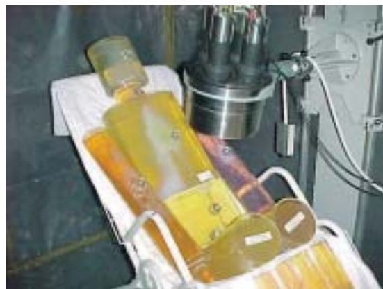
Fantoccio di calibrazione del Whole Body Counter
