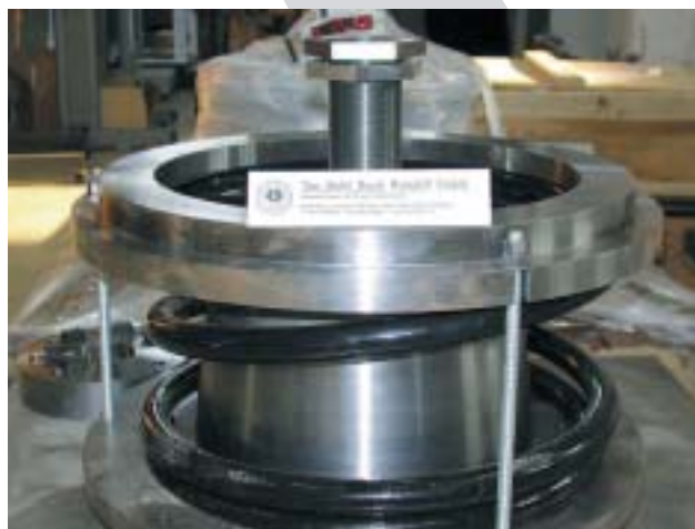
Isolatore sismico 3D del sistema di supporto realizzato dall'ENEA
