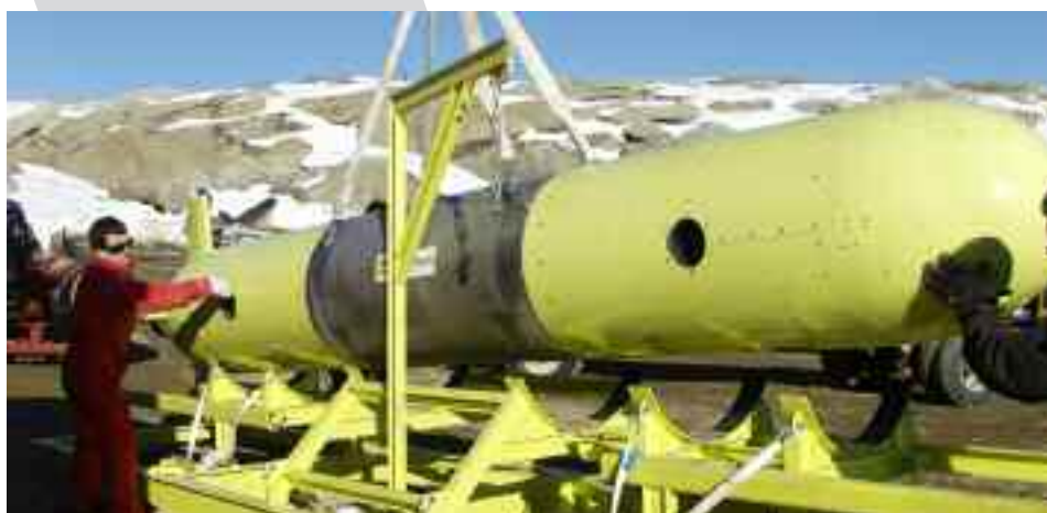
SARA, Sottomarino Autonomo per l'esplorazione del mare antartico ai fini della raccolta di dati idrologici, chimici, biologici e geologici
