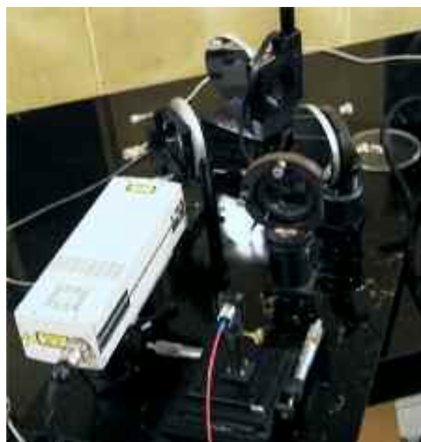
Sistema mobile "LIF scanning" per diagnostiche non distruttive sui beni culturali utilizzato in campagne di misure su affreschi
