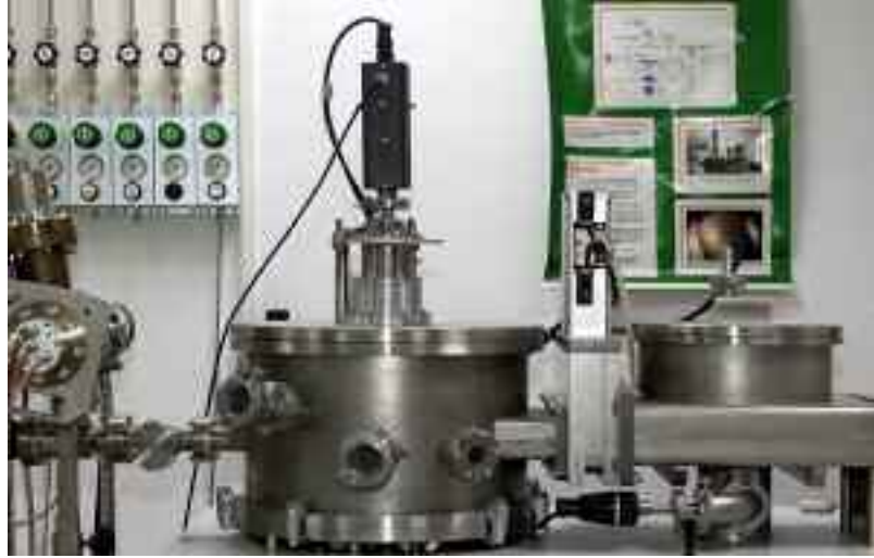
Laboratorio chimica dei plasmi. Impianto per attacco ionico reattivo
