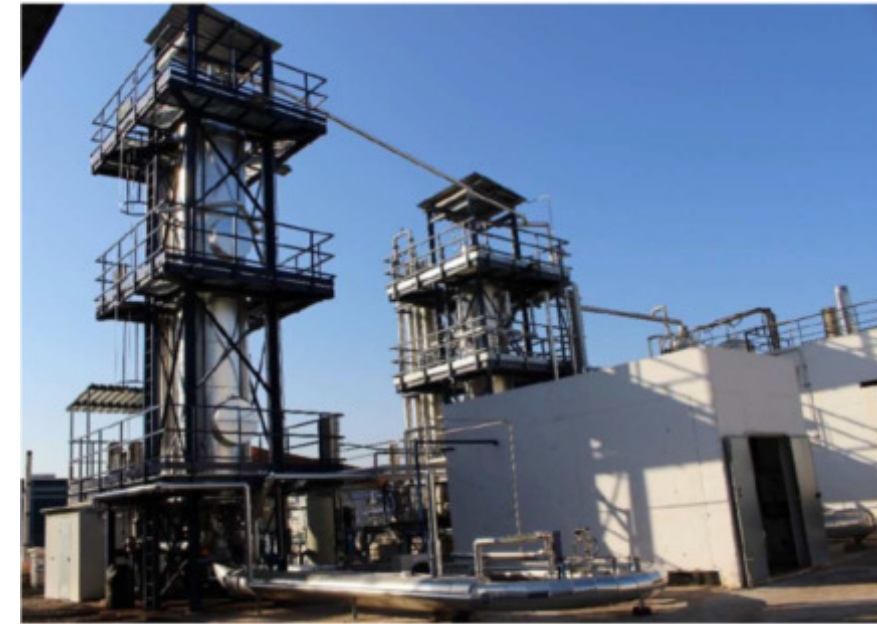
Prova di carbonizzazione su scala industriale presso l'impianto HTC Ingelia di Naquera (Valencia, Spagna) su fango secondario disidratato @18% SS
