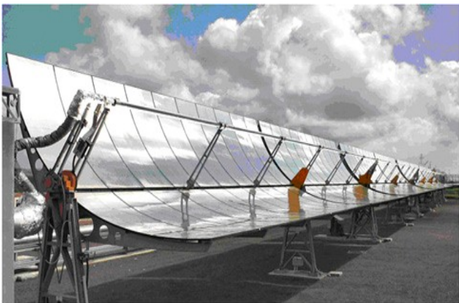
Impianto PCS per prova componenti solari (Centro Ricerche ENEA Casaccia)
