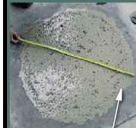
Segregación de la pasta de cemento.
