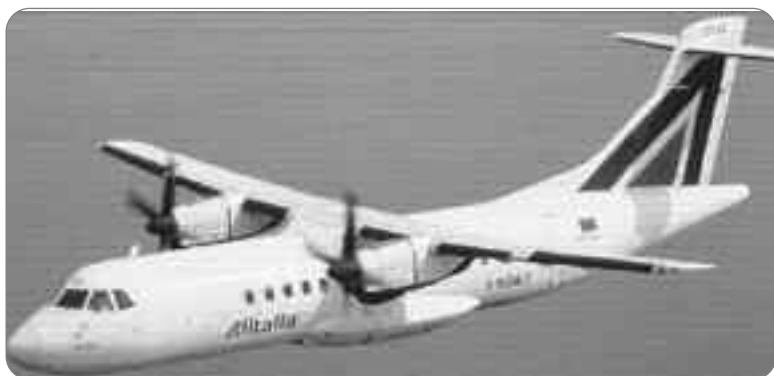
Figura 2a ATR42, velivolo bimotore con una lunghezza di 22,7m e cabina larga 2,6m prevede il trasporto di 42 passeggeri
