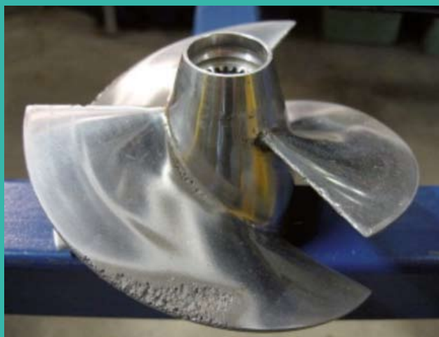
FIGURA 4 Elica con danni provocati dalla cavitazione, in particolare in vicinanza del bordo, dove la velocità della lama è massima
