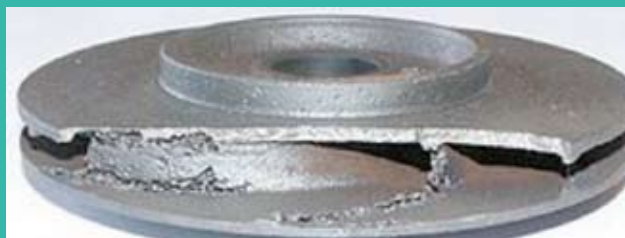
FIGURA 3 Girante di una pompa danneggiata dalla cavitazione
