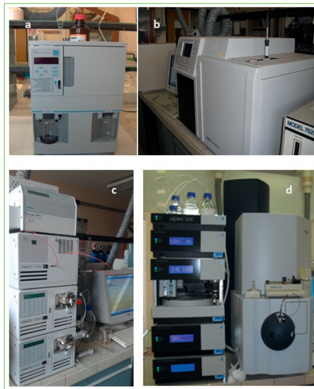
Figura 1 Principali strumentazioni analitiche impiegate per le analisi di nutraceutici: a) estrattore PLE; b) gas-cromatografo (GC); c) cromatografo liquido (HPLC-UV/Visibile); d) cromatografo liquido-spettrometro di massa (UHPLC-MS)
