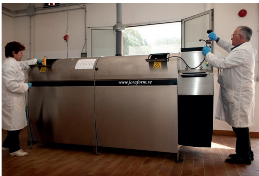
Figura 2 Compostatore a 2 camere sito presso il Centro Ricerche ENEA Casaccia
