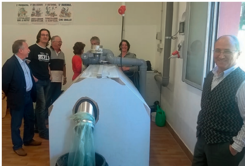
Figura 1 Compostatore a 1 camera sito presso il Centro Ricerche ENEA Casaccia
